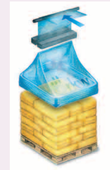
Paso 2: rizado uniforme, sellado y tronzado de la funda de film.
